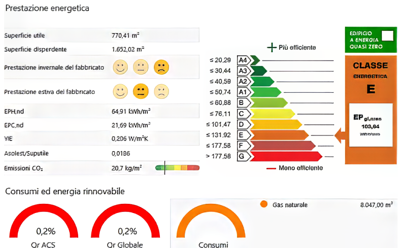
Figura 2.5. Classificazione energetica dell'edificio nello stato pre-intervento
