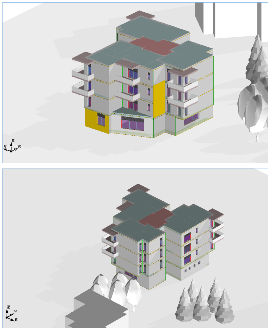
Figura 2.4. Viste 3D dell'edificio considerato, con alcune alberature e gli edifici confinanti per poterne valutare gli effetti dell'ombreggiamento sull'involucro oggetto di verifica
