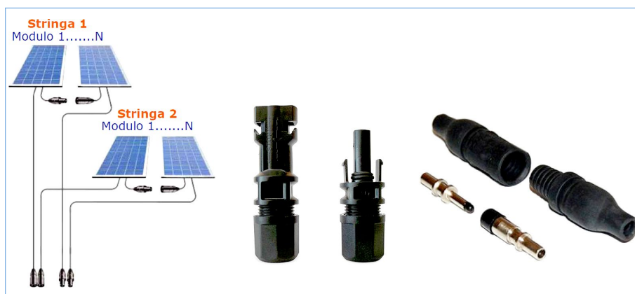
Figura 6.1. Interconnessione dei moduli a costituire stringhe da attestare successivamente ad un quadro o inverter
