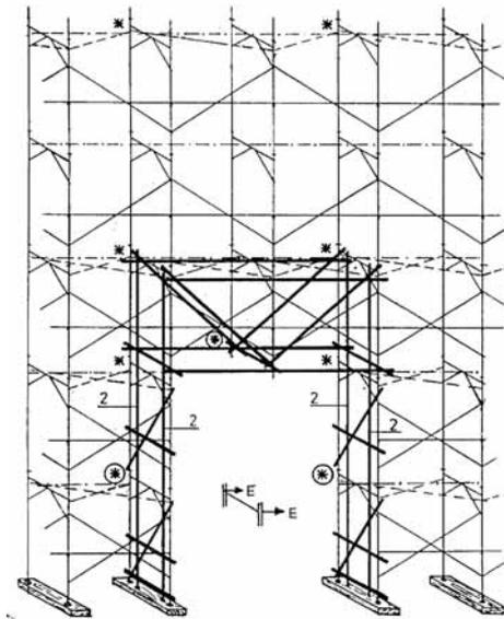
Fig. 7 – Passo carraino in tubi e giunti
