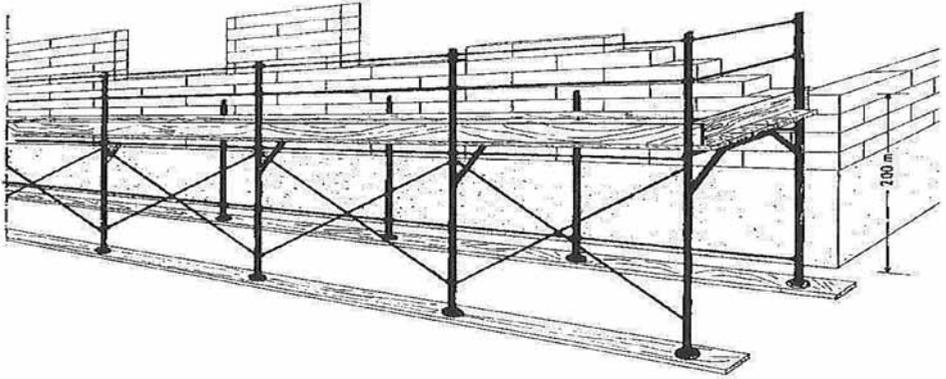
Fig. 1 – Altezza minima di un ponteggio
