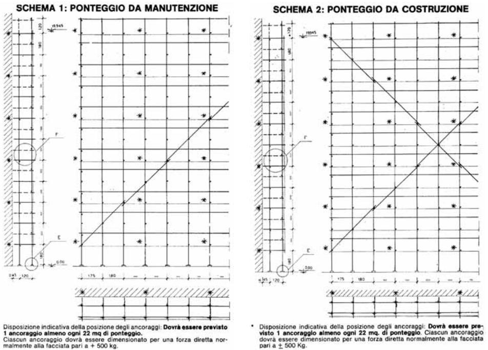
Fig. 4 – Ponteggio in “tubi e giunti” da manutenzione e da costruzione
