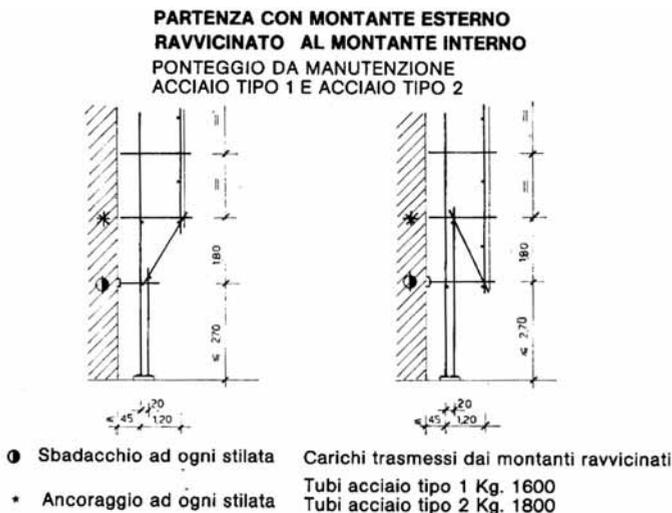
Fig. 6 – Schema per montanti ravvicinati
